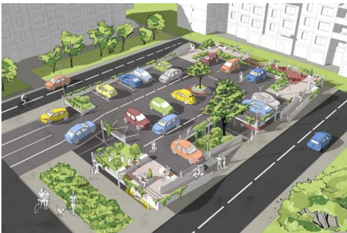
Mod de amenajare parcare 2 nivele cu nivelul superior axat pe locuri de parcare
