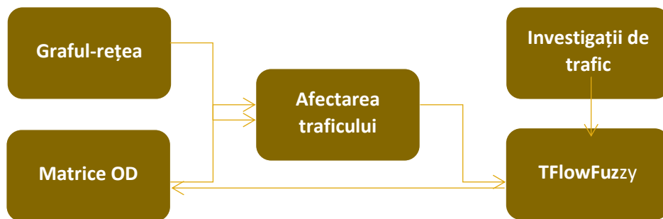
Figură 70 - Schemă a logică a procesului de calibrare utilizat
